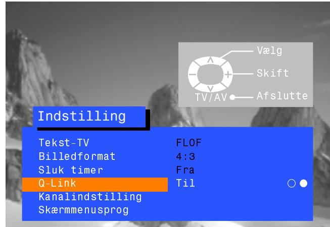
Videomaskinen skal tilkobles med en SCART-ledning, (alle ledninger ført igennem) der fastgøres mellem AV2 stikket på TV-apparaturet og det korrekte stik på videomaskinen. Se videomaskinens manual for yderligere oplysninger. Q-link, NEXTVIEWLINK eller lignende teknologier muliggør, at TV-apparaturet kan få en kompatibel videomaskine til at optage programmet, der aktuelt vises på skærmen, og ligegyldigt om programpositionen er indstillet på videomaskinen. Dette forenkler optageprocessen.
