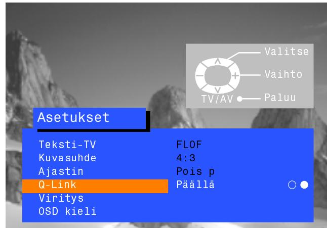
Kuvanauhuri on oltava kytkettynä SCART-johdolla (21-napainen) televisioon AV2-liitäntään ja kuvanauhuri vastaavaan liitäntään. Lisätietoja löytyy kuvanauhurin käyttöohjeesta. Q-Linkin, NEXTVIEWLINKIN tai vastaavan tekniikan avulla televiisio voi välittää yhteensovivalle kuvanauhurille käskyn nauhoittaa käynnissä olevan ohjelman huolimatta siitä, mikä ohjelmapaikka on asetettuna kuvanauhurissa. Nämä nauhoitustoiminto yksinkertaistuu.
