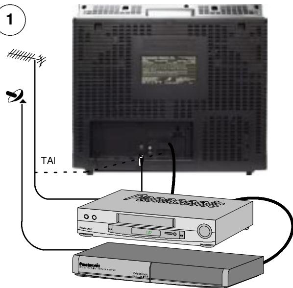
Kiinnitä antenni ja kytke muut varusteet.
